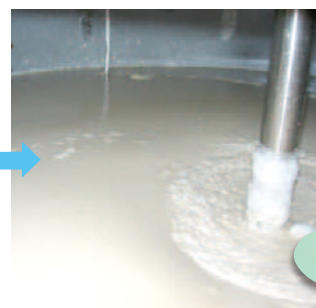
CM-1 添加攪拌 (約10分、反応槽) 排水1m 3 あたりCM-1を5g 使用します。
